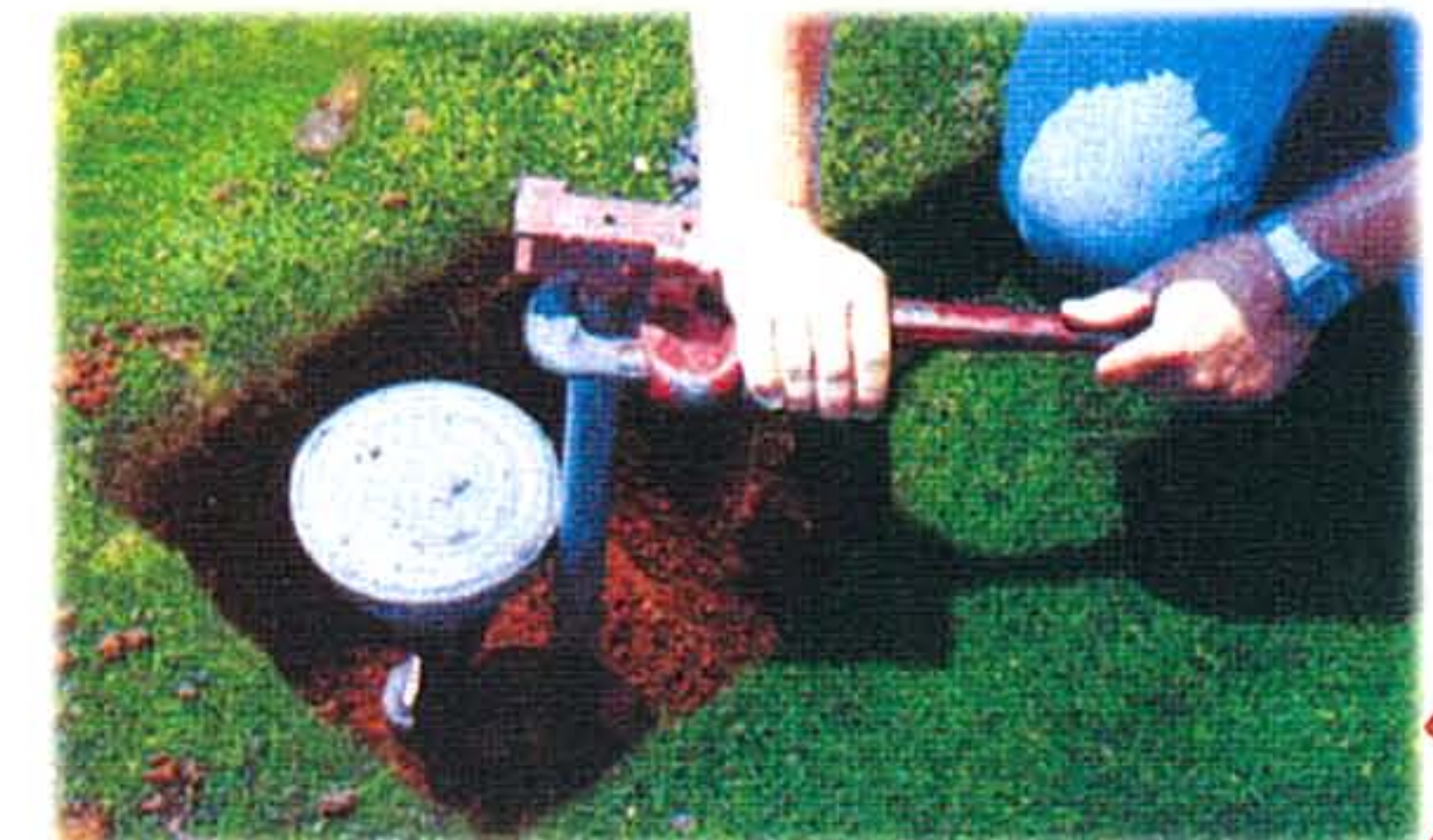
542 パッチカル・パイプ・レンチ スプリンクラーヘッド取換、点検に！ 地上部で操作できるのが特長で、掘削穴の大きさは従来の1/4です。最大サイズ:2インチまで
