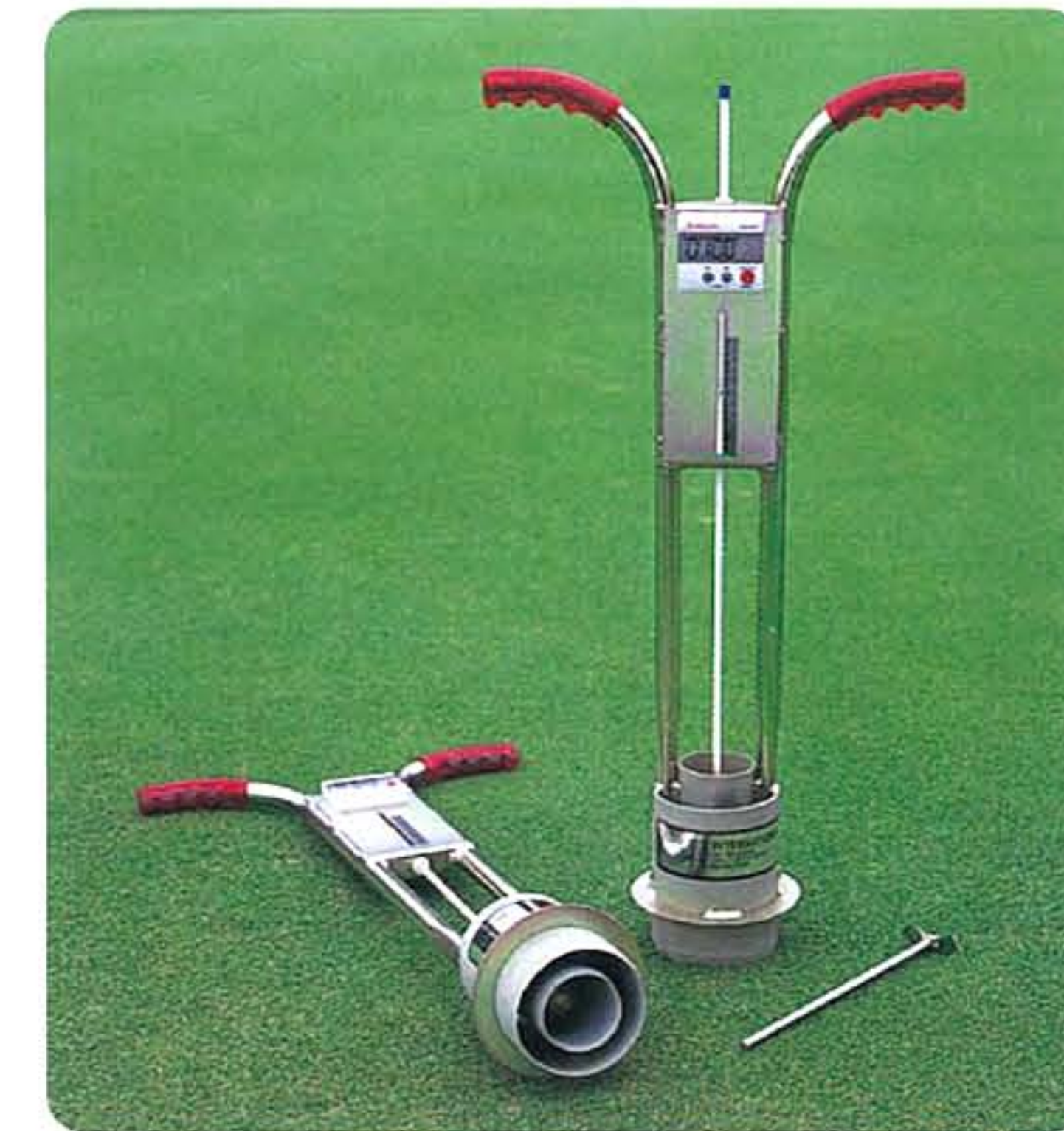
1000 インフィルトロメーター(水浸透速度計) ターフエリア専用の水の浸透速度を現場で測定することが出来ます。浸透速度データーを散水管理に生かすことも出来、エアレーション、パッチカット、トップドレッシング等の作業効果を数字で把握することが出来ます。浸透速度が「2.5cm/h以下」のグリーンは危険の境界線にあると理解すべきです。(ターフテック社製)
