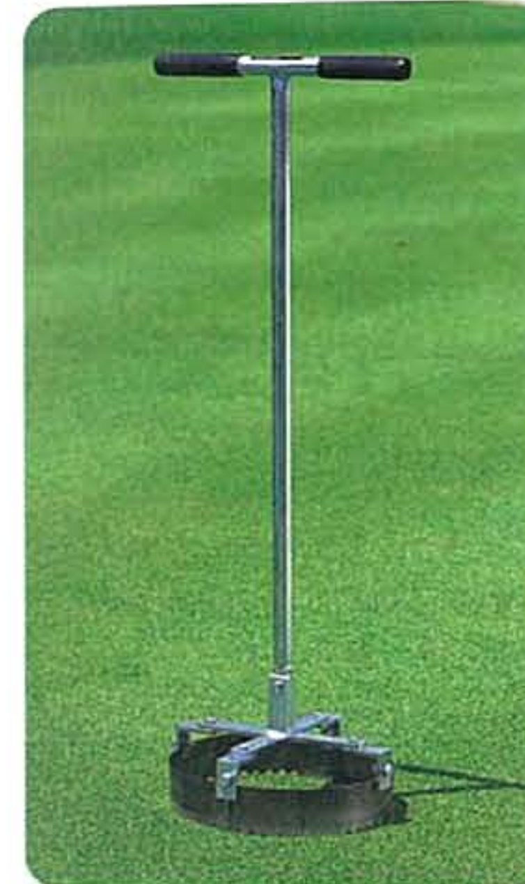
504-S スプリンクラーヘッドカッター 152φ~265φまでサークルを10段階に変更でき、2枚の鋸刃状ブレードが付きます。(散水後の作業が簡単です。)
